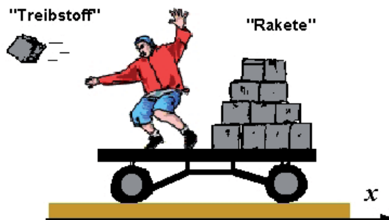
Abbildung 2.1: Modellvorstellung zum Raketenantrieb
